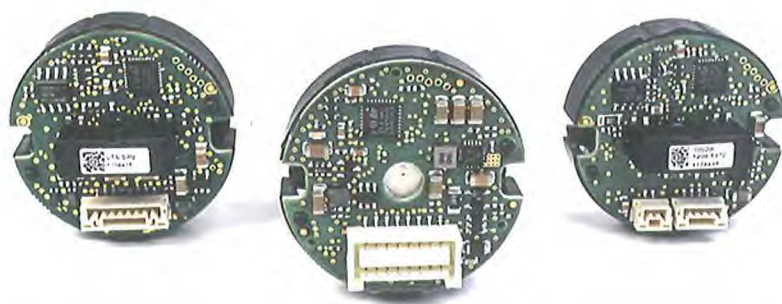
04 Die magnetischen Kit-Encoder bieten den Herstellern von Drehstrommotoren eine Alternative zu einfachen Resolvtern und optischen Drehgebern
