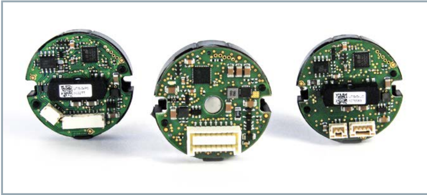
Das Elektronikpaket ist das Herzstück der magnetischen Kit-Encoder. (© Posital)
